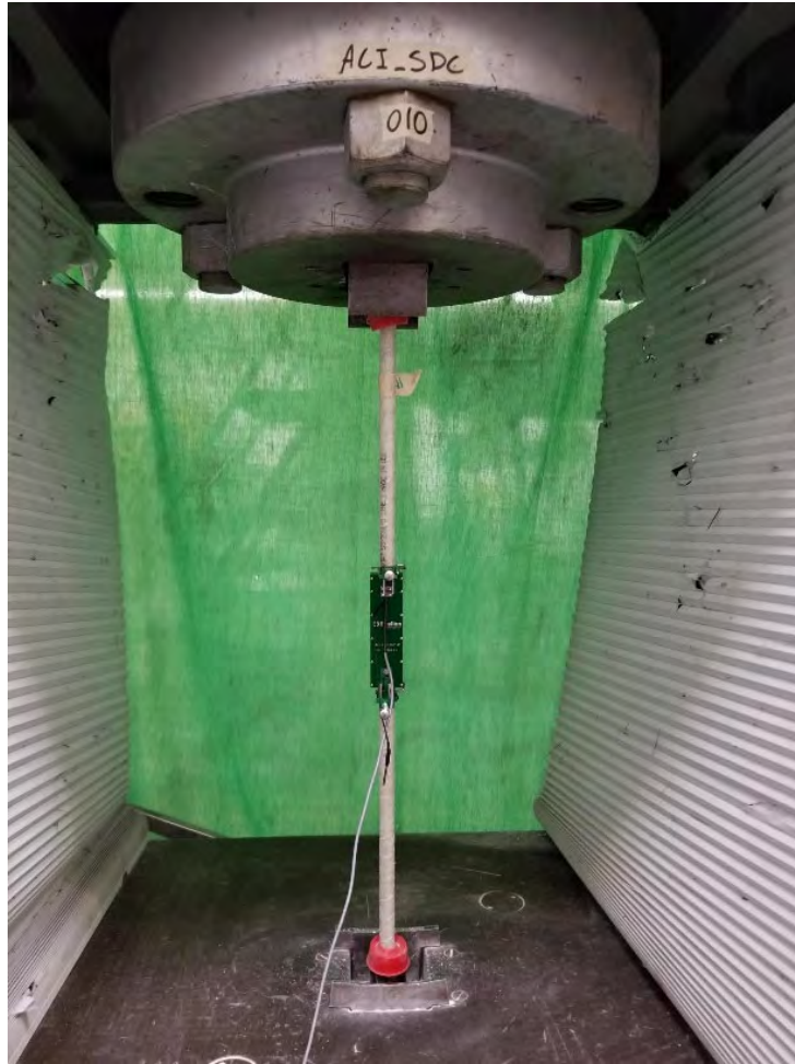
Fig. 53–Tensile test set up
